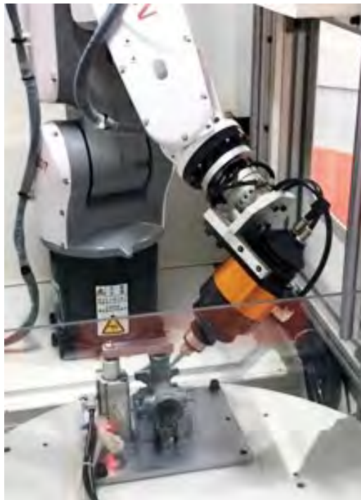
小型電力伝送電極 AC/DC200V 5Aの伝送可能
