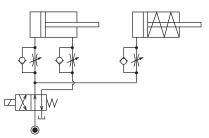
② 미터 아웃 회로의 경우, 공급량에 따라서는 실린더 동작 중에 회로 내압이 상승할 우려가 있습니다. 유량 조정 밸브를 사용해 실린더에 공급되는 유량을 미리 줄여서 회로 내압 상승을 방지할 수 있습니다. 특히 시퀀스 밸브 및 동작 확인 압력 스위치를 설치하는 시스템에서는 설정 압력 이상의 회로 내압이 발생하면 시스템이 성립하지 않게 되므로 충분한 검토가 필요합니다.
