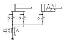
② 미터아웃 회로의 경우, 공급유량에 따라서는 실린더 동작중에 회로내압이 상승할 염려가 있습니다. 유량조정변을 이용하여 실린더 에 공급되는 유량을 미리 작게하는것으로, 회로내압의 상승을 방지할수가 있습니다. 특히, 시퀀스 밸브나 동작확인의 압력스위치를 설치하는 시스템에서는, 설정압 이상의 회로내압력이 발생하면 시스템이 성립하지 않으므로 충분히 고려해 주십시오.
