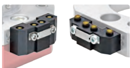
小型電力伝送タイプ 5A 4極 (総電流容量12A)
