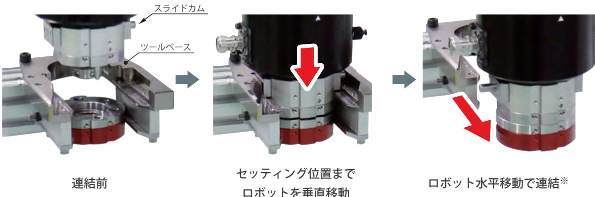
※水平移動時、スライドカムがツールベースに接触し動作します。この時、ロボットに負荷が加わります。
