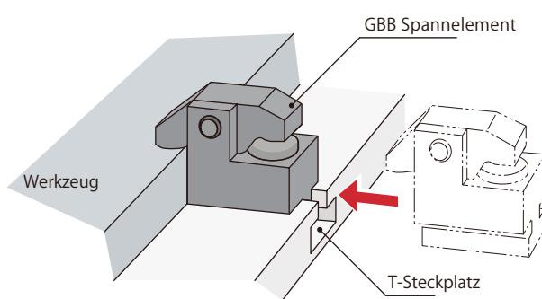
※ Wir liefern ein GBB Spannelement, das auf die Werkzeugspannstärke und die T-Steckplatzabmessung abgestimmt ist. Einzelheiten dazu finden Sie in den Abmessungen-Infos.
