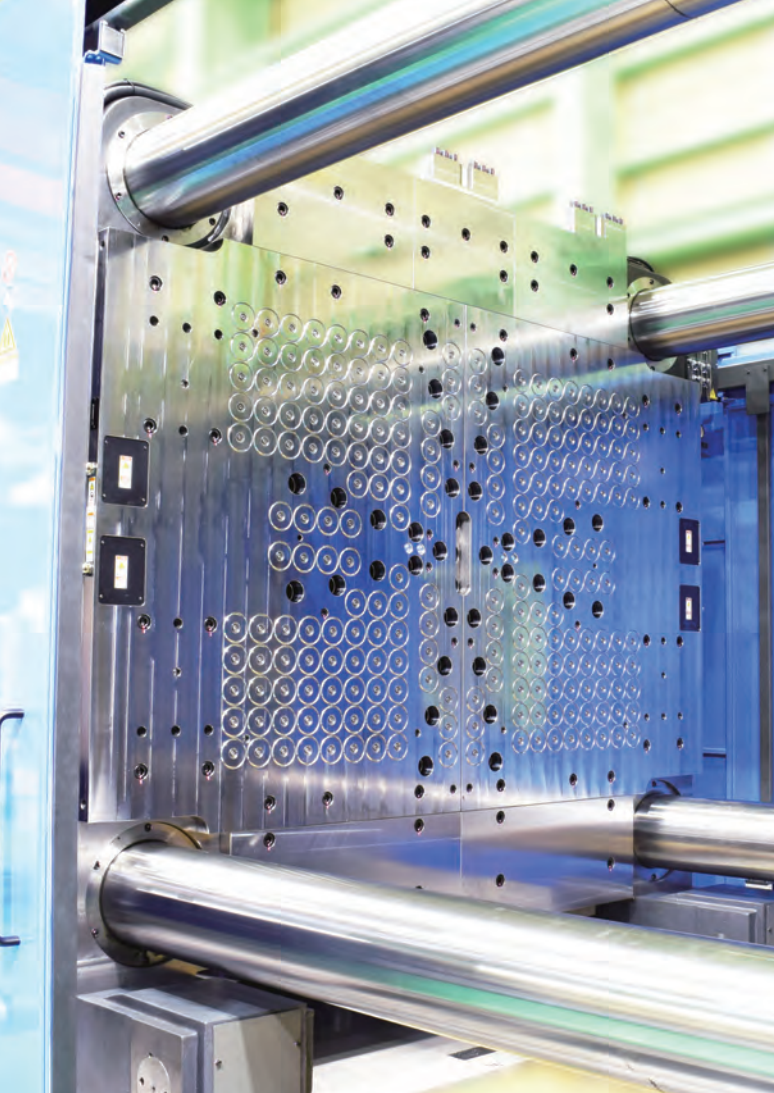
注塑机能力：1800ton级别、电磁板：MAK180□ (板厚50mm、控制单元数量8、对应温度100℃、MIMS规格)
