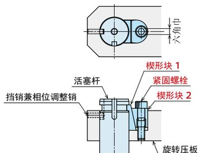
快换压板A型的安装用紧固套件
