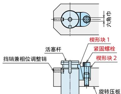
快换压板A型的安装用紧固套件
