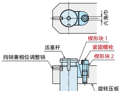
快换压板A型的安装用紧固套件
