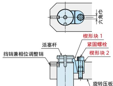
快换压板A型的安装用紧固套件
