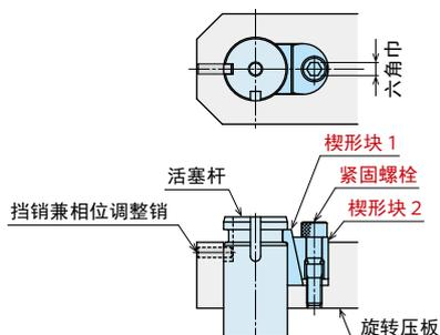
快换压板A型的安装用紧固套件。
