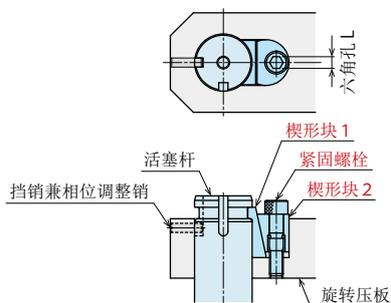
快换压板A型的安装用紧固套件
