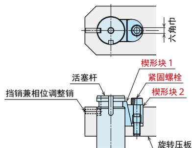
快换压板A型的安装用紧固套件
