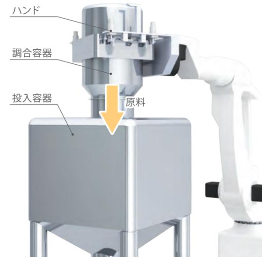
原料の固着を崩すために、ロボットによって原料の入った調合容器を振る必要があり、それに耐えるハンドが必要でした。500kgを超える容器ですから、通常のシリンダをいくら大型化しても容器が滑り落ちてしまう。そこで、コスメックのハイパワーエアクランプとハイパワーエアワークサポートが必要になります。保持力をもったハイパワーエアクランプと、当たった位置で対象物を支えることができるハイパワーエアワークサポートによって調合容器を確実に固定することができ、さらにハンドを軽量・コンパクトにすることができました。
