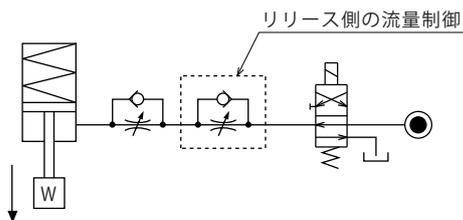
● 複動シリンダの速度制御回路
