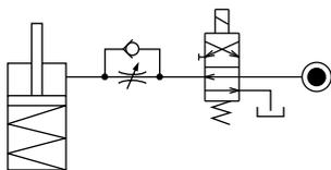
リリース時に、リリース動作方向に負荷がかかりシリンダを破損させる恐れのある場合は、チェック弁付流量調整弁を使用し、リリース側の流量も制御してください。
