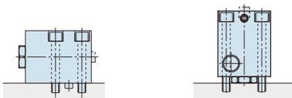
**A** :Horizontale Montage    **B** :Vertikale Montage
