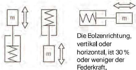
Beispiel ) Bei LC0402-L, maximale Masse der Kontaktschraube =  $4.7 \times 0.3 / 9.807 = 0.14 \text{ kg}$  wenn die Anlegefederkraft 4.7-7.8 N beträgt.
