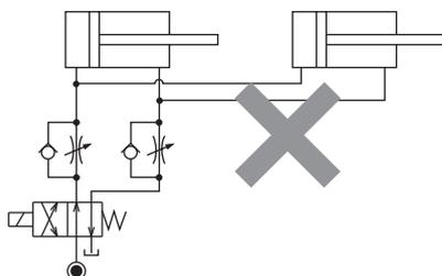
Im Falle einer Rücklaufregelung sollte der Hydraulikplan mit den folgenden Merkmalen konstruiert sein.
