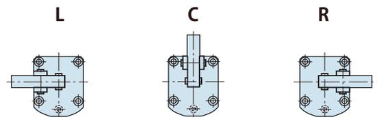
※ Die Abbildungen zeigen die Hebelausrichtung, wenn der Verrohrungsanschluss vor Ihnen liegt.
