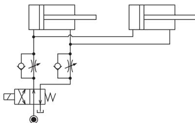
【Zulaufregelung】 (LKE/TMA/TLA müssen mit einer Zulaufregelung geregelt werden.)
