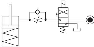
Eine beschleunigte Spanngeschwindigkeit durch einen übermäßigen Hydraulikfluss zum Zylinder kann zu Schäden führen. In diesem Fall fügen Sie eine Volumenstromregelung hinzu, um den Volumenstrom zu regeln. (Wenn Schwenkspanner verwendet werden, fügen Sie eine Volumenstromregelung hinzu, um den Volumenstrom freizugeben, wenn das Hebelgewicht während des Lösevorgangs aufgesetzt wird.)
